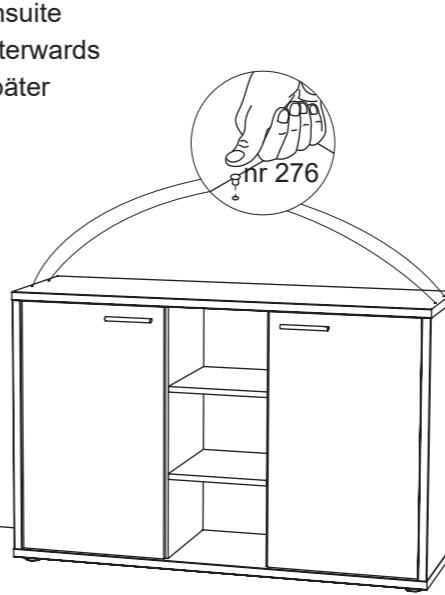
Voor de juiste regeling van de deuren moet U ervoor zorgen dat de kast goed waterpas staat, ook kunt U met de schroeven van de scharniere 201 de deuren bijregelen. U kan ook de deuren verticaal bijregelen. Ontspan vijzen A en schuif de scharnierblok nr. 203 naar onder of naar boven en schroef terug vast.
